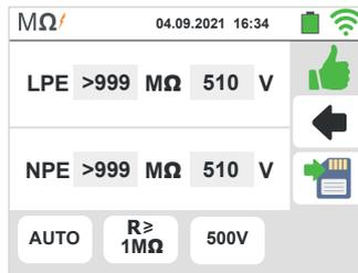
**AUTO Isolationsmessung mit L/N und L/PE**
