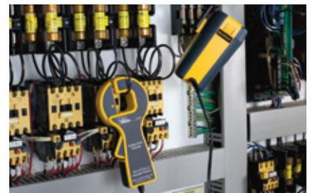
Die Induktions-Zange ermöglicht die Einspeisung eines Signals auf das Kabel ohne direkte Kontaktmöglichkeit (z. B. Kabelkanälen, Kabelschacht)
