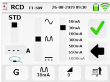
Auswahlmenü RCD Messung Typ A, AC, B, F
