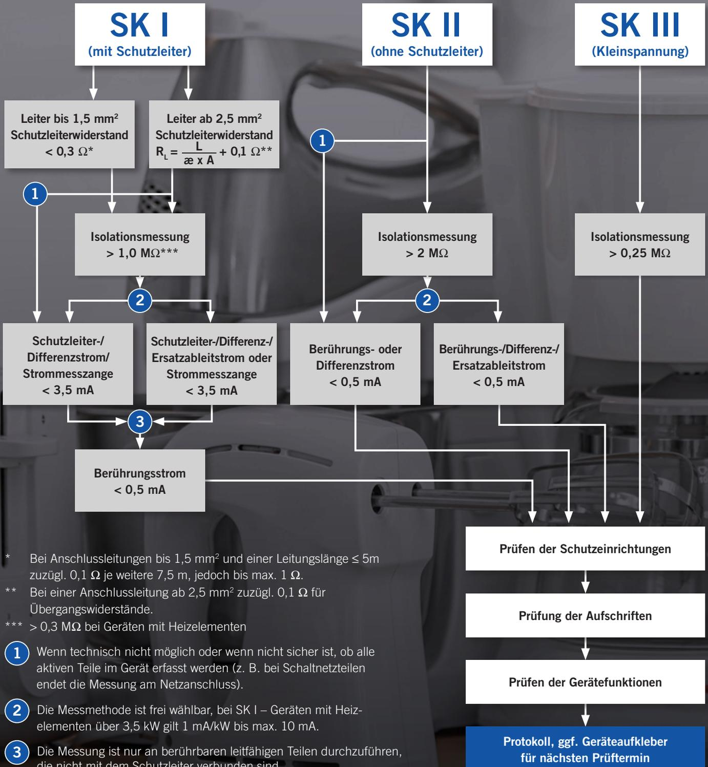
\* Bei Anschlussleitungen bis 1,5 mm<sup>2</sup> und einer Leitungslänge ≤ 5m zuzügl. 0,1 Ω je weitere 7,5 m, jedoch bis max. 1 Ω.
