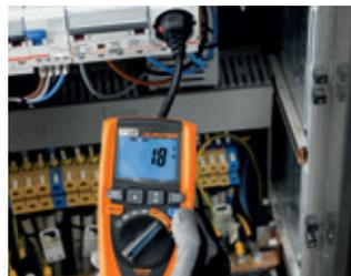
Impedanzmessung ohne RCD-Auslösung
