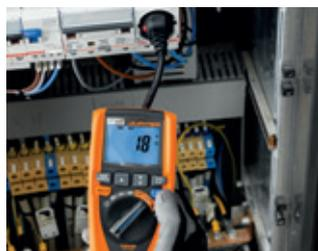
Impedanzmessung ohne RCD-Auslösung
