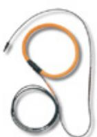
Flexible Stromwandler für die Messung von AC
