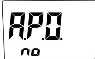
Abb. 36: Deaktivierung der Auto Power OFF Funktion
