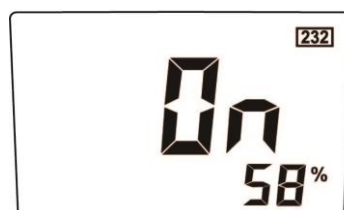
Abb. 35: Aktivierung des Modus RS232
