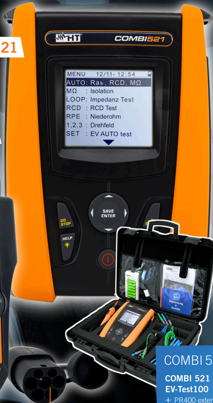
EV-TEST100 Prüfadapter für E-Ladestationen mit Stecker Typ 2
