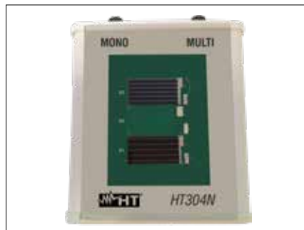
HT304N Duo-Referenzzelle für Einstrahlungsmessung
