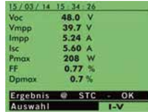
Messwertergebnis in Funktion I-U Kennlinienmessung
