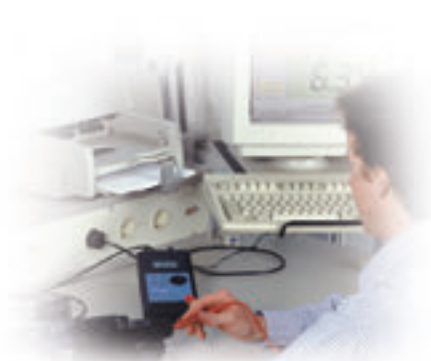
CEE Test 16A: Zum Messen des Differenzstromes von 3-phasigen Prüflingen unter Last.
