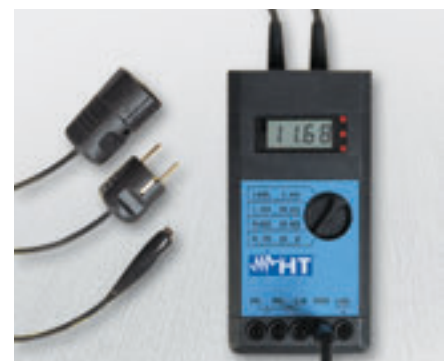
CEE Test 16A: Zum Messen des Differenzstromes von 3-phasigen Prüflingen unter Last.
