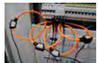
Lieferumfang: inkl. 4 flexiblen Stromwandlern (300 A / 3000 A)
