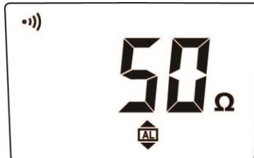
Abb. 33: Einstellung von Alarm-Schwellen bei Widerstandsmessungen
