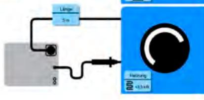
Bitte den Prüfling einschalten. Alle isolierten, berührbaren, leitfähigen Teile mit der Sonde abtasten.
