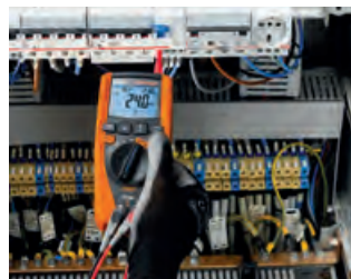
RCD Auslösezeit t_a und Auslösestrom I_a
