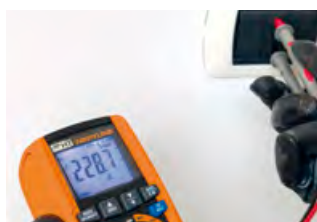
LoZ Funktion eliminiert Streuspannungen.
