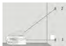
Indirekte auto. Messung mit Pythagoras Methode
