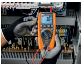
LoZ Funktion eliminiert Streuspannungen
