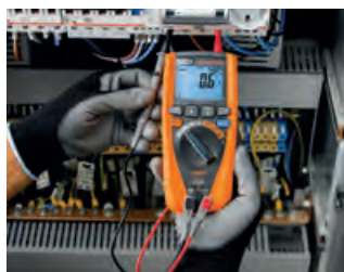
LoZ Funktion eliminiert Streuspannungen
