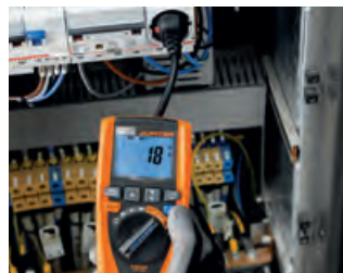
Impedanzmessung ohne RCD-Auslösung
