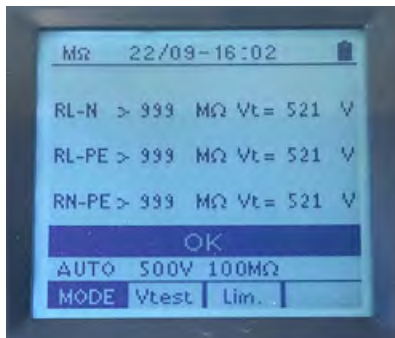
Isolationsmessung gegen alle Leiter L-N-PE
