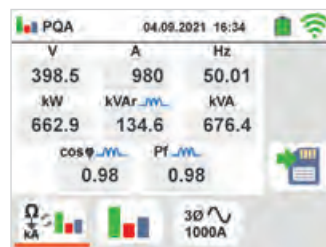
Leistungsanalyse Wirk-, Blind- & Scheinleistung
