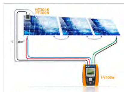
Anschluss I-V500w direkt an HT304K
