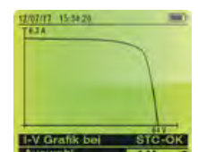
Auswertung und Protokollerstellung der U-I Kennlinie mit Ihrem Smartphone oder Tablet und der App HTANALYSIS™
