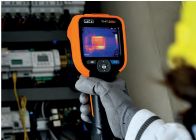
Ein überhitzer Lüftermotor aufgenommen mit der THT300
