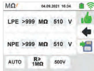
AUTO Isolationsmessung mit L/N und L/PE Ergebnisanzeige
