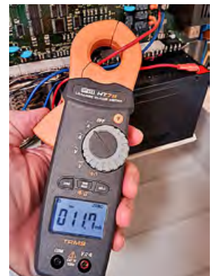
Messung an der Alarmanlage (Ladestrom / Betriebsstrom)
