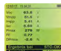
Auswertung und Protokollerstellung der U-I Kennlinie mit Ihrem Smartphone oder Tablet und der App HTANALYSIS™
