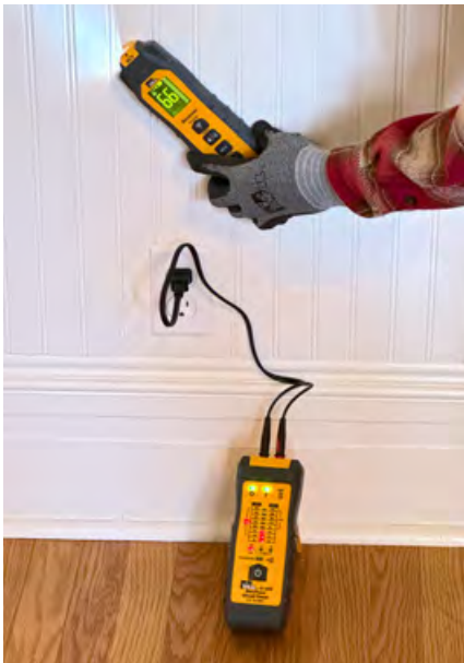
Leitungen in Decken, Wänden und Fußböden finden und verfolgen.
