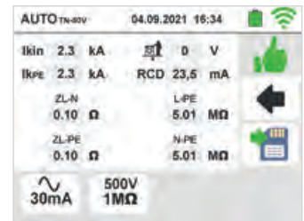
AUTO-Sequenz (autom. Prüfablauf) ZLN => Ra => RCD Test => Riso
