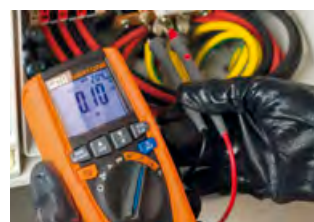
Durchgangsprüfung von Schutzleitern.
