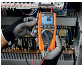
LoZ Funktion eliminiert Streuspannungen
