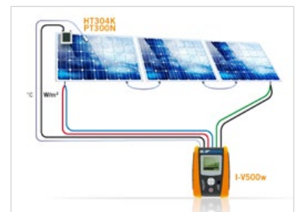
Anschluss I-V500w direkt an HT304K
