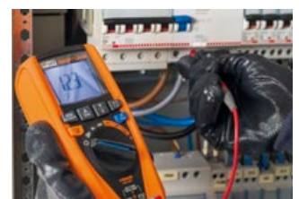
Drehfeldrichtung mit 1-phasiger Methode.
