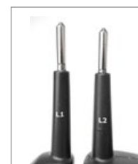
Mit aufgeschraubten Metallhülsen 4 mm
