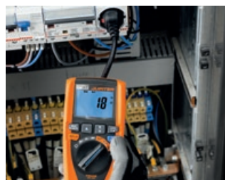
Impedanzmessung ohne RCD-Auslösung
