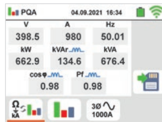
Leistungsanalyse Wirk-, Blind- & Scheinleistung
