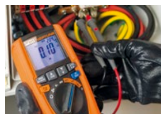
Durchgangsprüfung von Schutzleitern.
