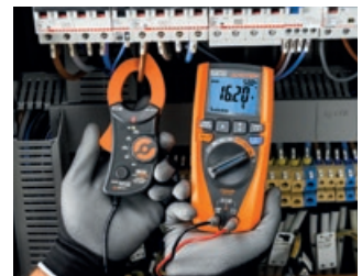
AC+DC Strommessung TRMS
