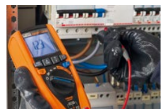
Drehfeldrichtung mit 1-phasiger Methode.
