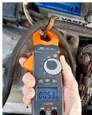
Ruhestrommessung an der Autobatterie ohne Auftrennen der Leiter
