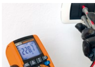
LoZ Funktion eliminiert Streuspannungen.
