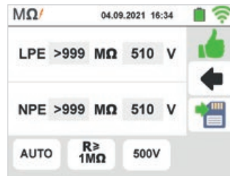
AUTO Isolationsmessung mit L/N und L/PE Ergebnisanzeige
