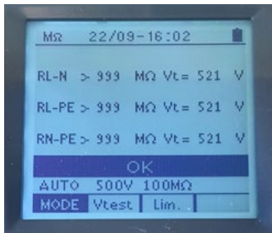
Isolationsmessung gegen alle Leiter L-N-PE
