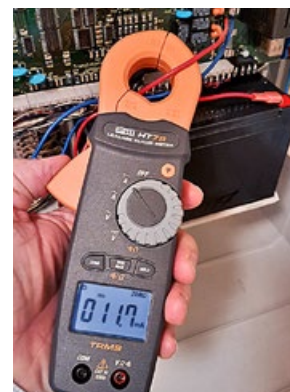
Messung an der Alarmanlage (Ladestrom / Betriebsstrom)
