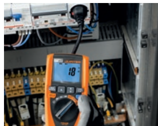
Impedanzmessung ohne RCD-Auslösung
