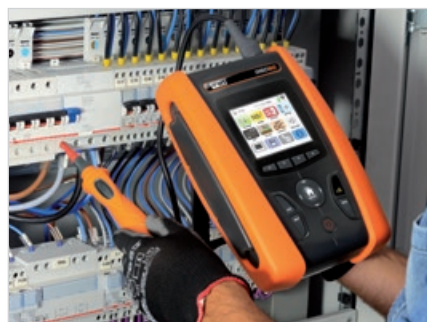
GSC60 mit externer Prüfsonde PR400
