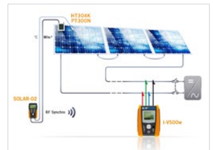
Anschluss I-V500w an HT304K über externen Datenlogger SOLAR-02
