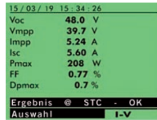
Messwertergebnis in Funktion I-U Kennlinienmessung
