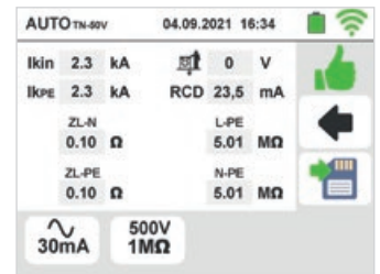
AUTO-Sequenz (autom. Prüfablauf) ZLN => Ra => RCD Test => Riso
