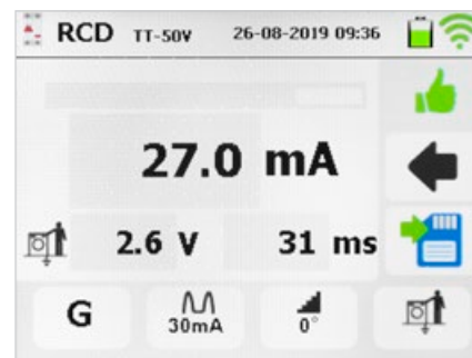
RCD Messung Ergebnis Auslösezeit ta Auslösestrom Ia und UB
