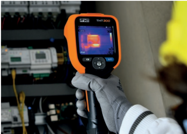
Ein überhitzer Lüftermotor aufgenommen mit der THT300
