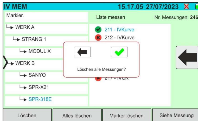
Abb. 97: Löschung des gesamten internen Speichers
