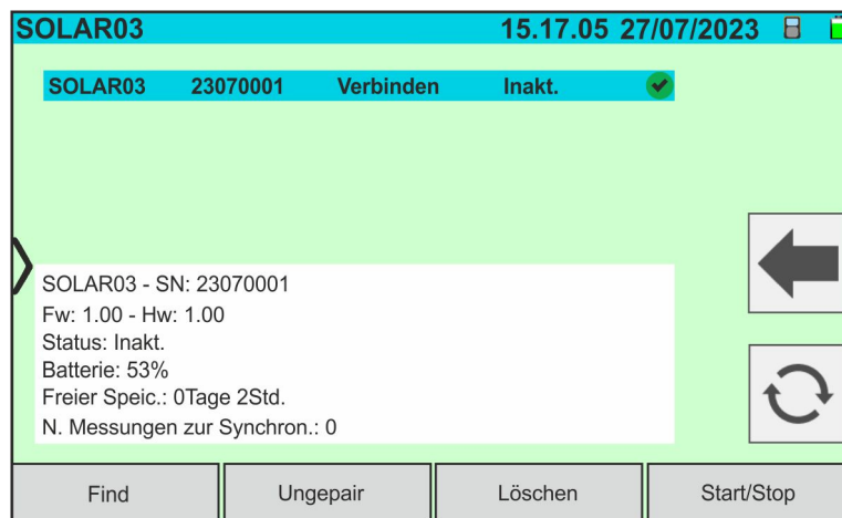
Abb. 18: Verbindung Fernstation SOLAR03 – Schritt 4
