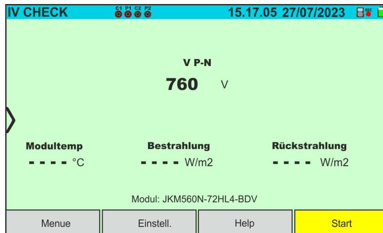
Abb. 75: I-V-Test mit SOLAR03 bei synchroner Aufzeichnung bei Bifazialen Modulen
