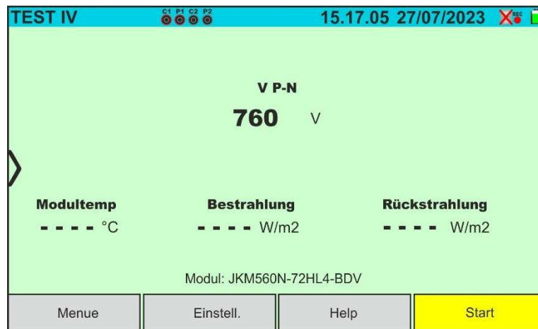
Abb. 52: I-V-Test mit SOLAR03 bei synchroner Aufzeichnung bei Bifazialen Modulen
