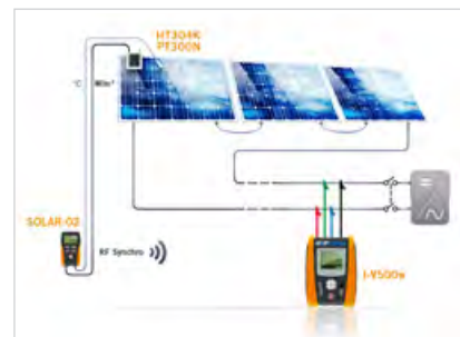
Anschluss I-V500w an HT304K über externen Datenlogger SOLAR-02
