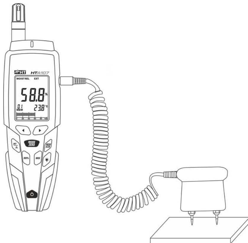
Abb. 9: Verwendung des Geräts zur Messung der Feuchtigkeit mit dem externen Fühler
