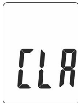
Abb. 6: Nullstellung des internen Speichers
