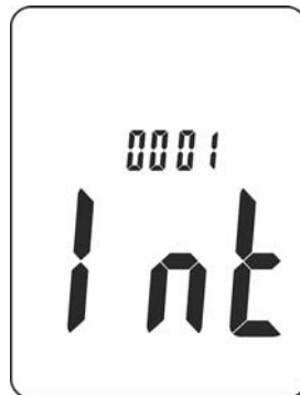
Abb. 7: Einstellung des Abtastintervalls
