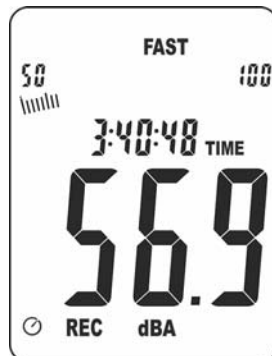
Abb. 8: Aktivierung der Aufzeichnung des SPLs
