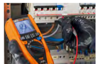
Drehfeldrichtung mit 1-phasiger Methode.
