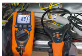
Messung des Stroms mit flexiblem Wandler.
