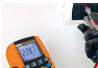
LoZ Funktion eliminiert Streuspannungen.
