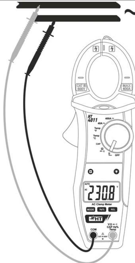
Abb. 4: Verwendung der Zange für Wechselfspannungsmessung
