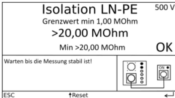
Bei dieser Messung wird L und N im Prüfgerät verbunden und mit 500 V (bei „Überspannungsableiter: Ja“ mit 250 V) gegen PE beaufschlagt und der Isolationswiderstand gemessen.
