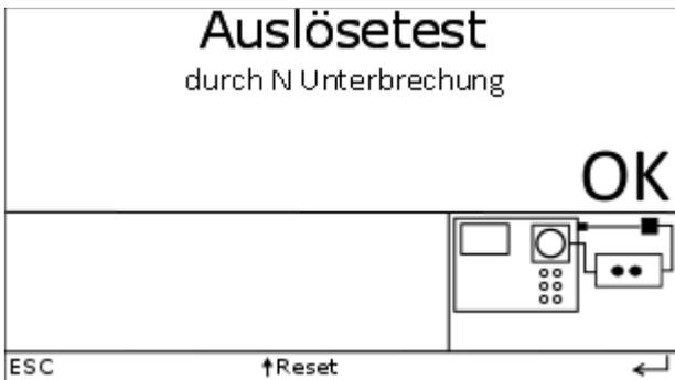
Nach Netz einschalten, nur bei PRCD-K. Diese Messung prüft die Durchgängigkeit des Varistors über dem PE-Leiter beim PRCD-K
