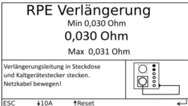
Bei der CEE-Verlängerung wird die Sonde an den PE des Verlängerungsadapters angeschlossen. Hier wird die RPE Stecker Messung verwendet.
