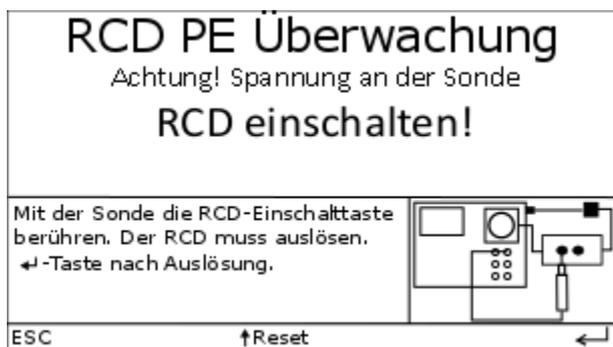
Die Isolation der offenen PRCD-S PE Verbindung wird überprüft.
