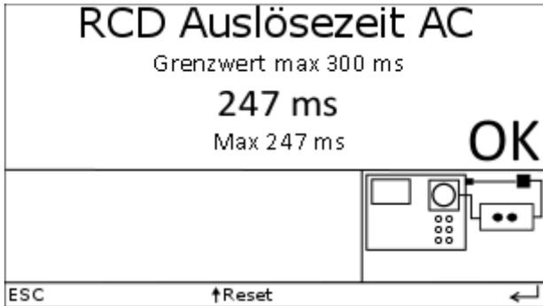
**Hinweis:** Vor Beginn der Messung wird der RCD mit einem Strom von ca. 10% des Nennfehlerstromes beaufschlagt. Sollte er bei diesem Strom bereits auslösen, wird „Messfehler“ angezeigt.
