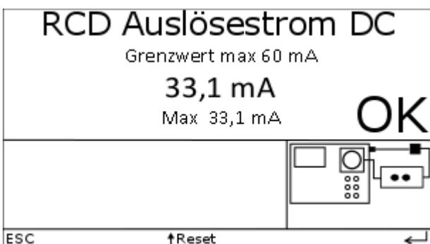
Bei RCDs mit einem Nennstrom von 300 mA oder 500 mA ist die Auslösestromprüfung nicht möglich.
