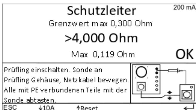
Entfällt bei Menü „RPE-Messung Nein“, entfällt bei „Mehr PE Punkte Nein“
