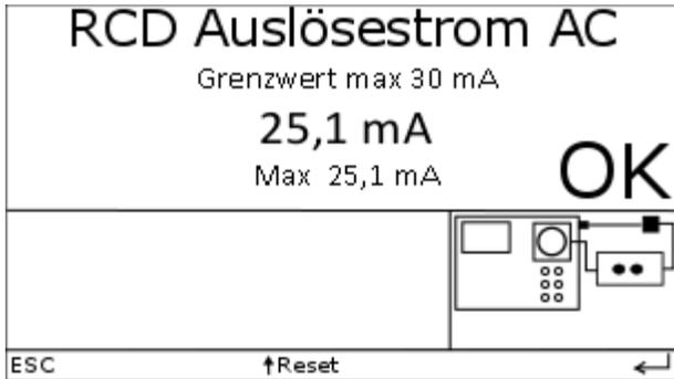
Bei RCD Typ B wird zusätzlich nach einer Einschaltaufforderung der Auslösestrom für DC ermittelt. Der Grenzwert liegt hier zwischen  $I_{dn}$  und  $2 \times I_{dn}$ .
