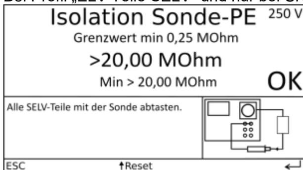
Die SELV Teile werden abgetastet. Der Isolationswiderstand gegen das Gehäuse wird gemessen. (Messspannung 250 V)
