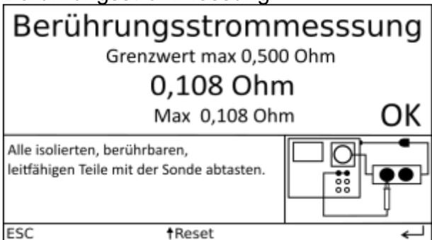
Schutzleiterwiderstandsmessung über das Anschlusskabel
