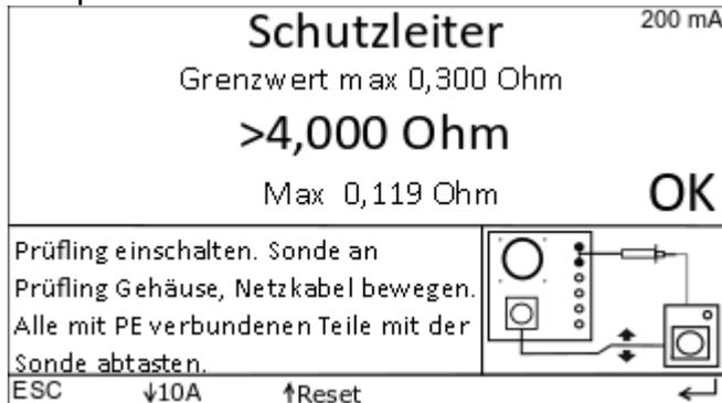
In der obersten Zeile steht die Überschrift für die Messung („Schutzleiter“), darunter der maximal oder minimal zulässige Wert für diese Messung.
