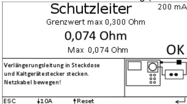
Da der PRCD-S elektronische Bauteile enthält ist eine Schutzleiterstrommessung erforderlich.
