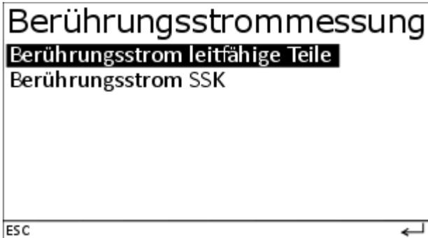
Die Messung Berührungsstrom SSK wird nur bei eingeblendet, wenn die Schweißgeräteeoption aktiviert ist.
