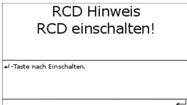
Nach der Umpolung werden die Differenzstrom- und Berührungsstrommessung in umgekehrter Netzpolarität wiederholt.
