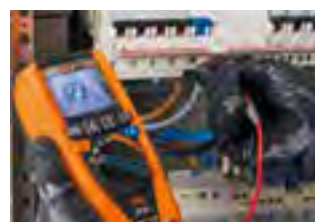
Drehfeldrichtung mit 1-phasiger Methode.
