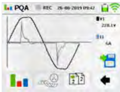
Netzanalyse Scopefunktion Spannung und Strom
