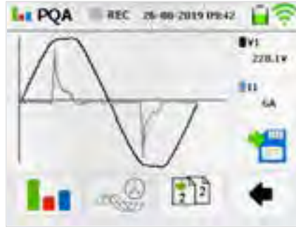
Netzanalyse Scopefunktion Spannung und Strom
