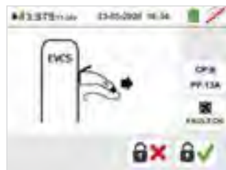
Verriegelungstest im Prüfablauf EVSE
