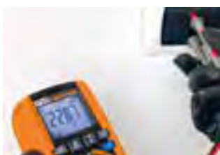
LoZ Funktion eliminiert Streuspannungen.
