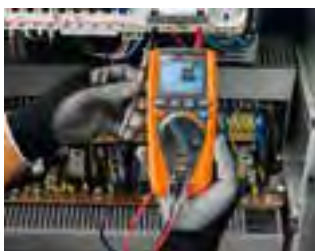
LoZ Funktion eliminiert Streuspannungen
