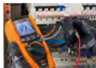
Drehfeldrichtung mit 1-phasiger Methode.
