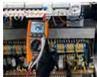
RCD Auslösezeit t_a und Auslösestrom I_a
