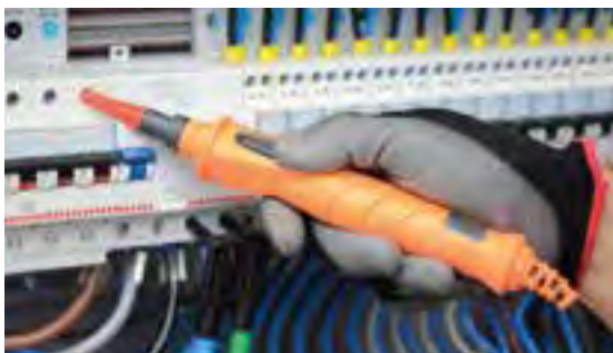
PR400 externer Tastkopf zur Fernbedienung
