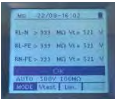
Isolationsmessung gegen alle Leiter L-N-PE
