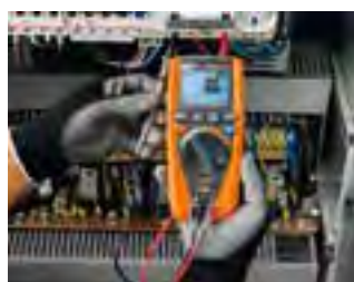
LoZ Funktion eliminiert Streuspannungen
