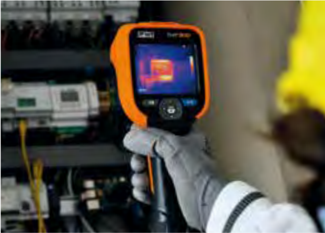
Ein überhitzer Lüftermotor aufgenommen mit der THT300
