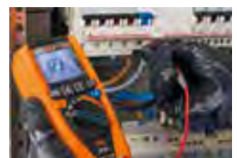
Drehfeldrichtung mit 1-phasiger Methode.
