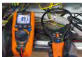
Messung des Stroms mit flexiblem Wandler.
