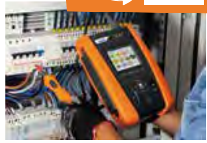
COMBI G3 im Einsatz mit externer Prüfsonde PR400 (Start/Stop)
