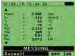
Messung / Aufzeichnung in der Funktion Leistungsanalyse
