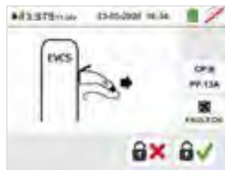
Verriegelungstest im Prüfablauf EVSE
