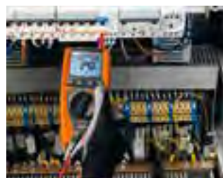
RCD Auslösezeit t_a und Auslösestrom I_a
