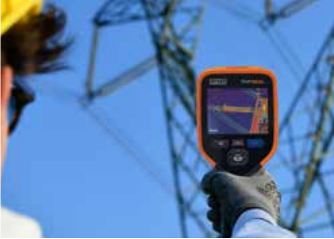
Hochspannungsisolator aufgenommen mit der THT600L
