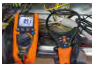
Messung des Stroms mit flexiblem Wandler.
