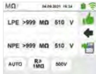
AUTO Isolationsmessung mit L/N und L/PE Ergebnisanzeige
