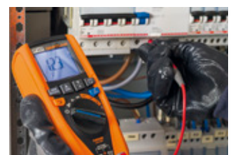
Drehfeldrichtung mit 1-phasiger Methode.
