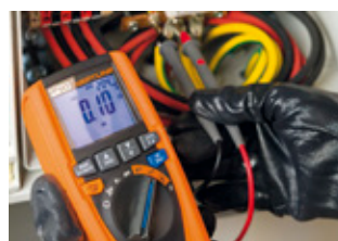
Durchgangsprüfung von Schutzleitern.
