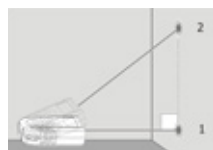
Indirekte auto. Messung mit Pythagoras Methode
