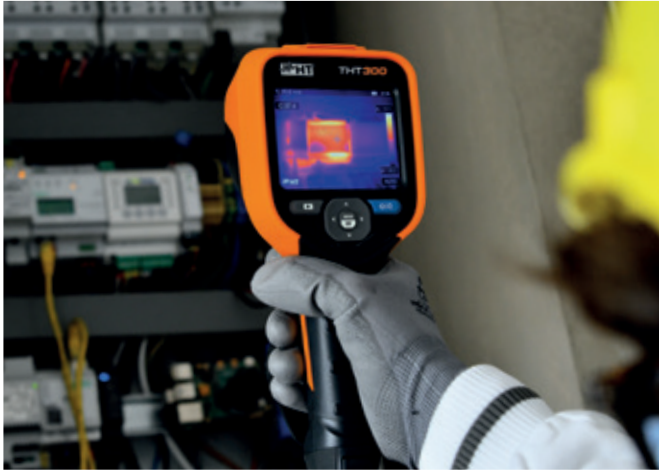
Ein überhitzer Lüftermotor aufgenommen mit der THT300
