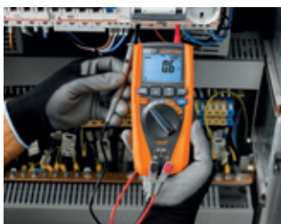
LoZ Funktion eliminiert Streuspannungen
