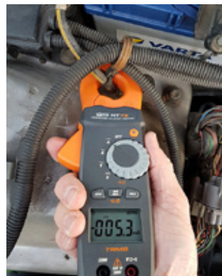
Ruhestrommessung an der Autobatterie ohne Auftrennen der Leiter
