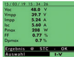
Messwertergebnis in Funktion I-U Kennlinienmessung
