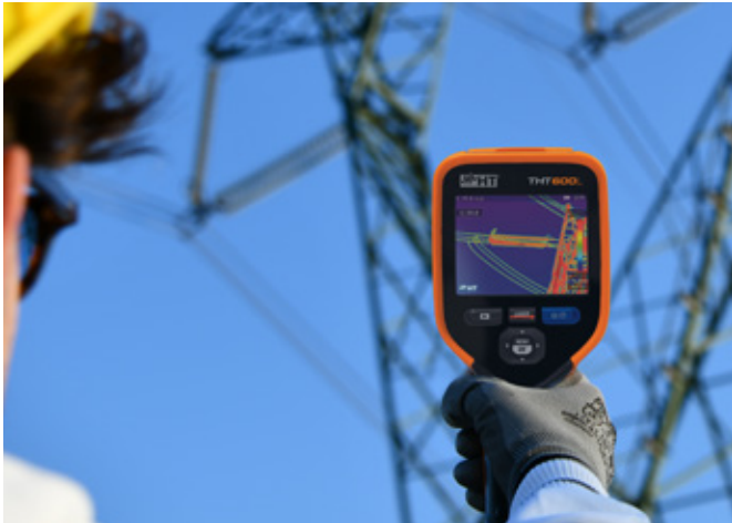
Hochspannungsisolator aufgenommen mit der THT600L
