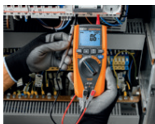
LoZ Funktion eliminiert Streuspannungen
