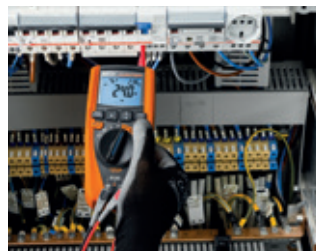
RCD Auslösezeit t_a und Auslösestrom I_a
