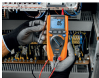
LoZ Funktion eliminiert Streuspannungen
