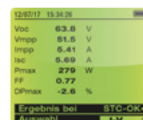
Auswertung und Protokollerstellung der U-I Kennlinie mit Ihrem Smartphone oder Tablet und der App HTANALYSIS™
