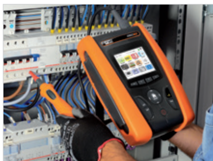
GSC60 mit externer Prüfsonde PR400
