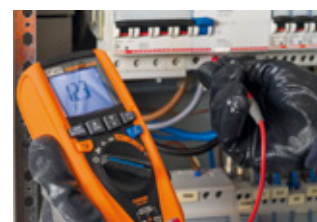
Drehfeldrichtung mit 1-phasiger Methode.
