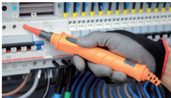
PR400 externer Tastkopf zur Fernbedienung
