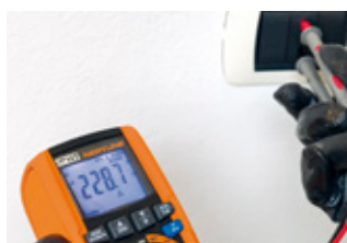
LoZ Funktion eliminiert Streuspannungen.
