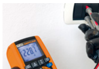
LoZ Funktion eliminiert Streuspannungen.
