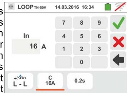
5. Bewegen Sie den Cursor auf der Leiste und wählen Sie die Auslösezeit der Sicherung/Schutzschalters zwischen: **0.1s**, **0.2s**, **0.4s**, oder **5s** aus.
