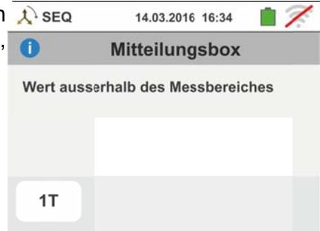
3. Erkennt das Gerät, dass die Frequenz der Eingangsspannung außerhalb des eingestellten Messbereichs liegt, wird der nebenstehende Bildschirm angezeigt
