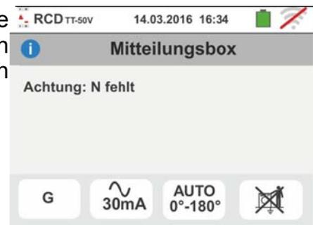
5. Wenn das Gerät kein Signal an der Eingangsbuchse B3 (PE-Leiter) ermittelt, zeigt es einen Warnbildschirm ähnlich dem hier nebenstehenden an und unterbricht jede Prüfung.
