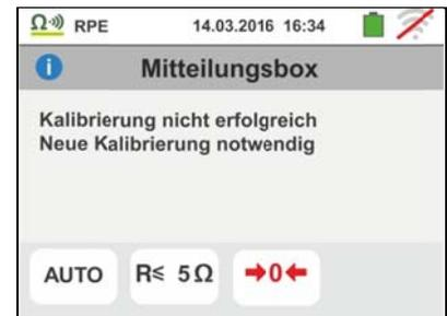
3. Wird erkannt, dass der kalibrierte Widerstand höher ist als der gemessene Widerstand, erzeugt das Gerät ein langes Tonsignal und zeigt einen Bildschirm ähnlich dem hier nebenstehenden an.
