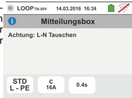
7. Erkennt das Gerät eine Vertauschung zwischen Phase- und PE-Leiter, führt das Gerät keine Prüfung durch und zeigt einen Bildschirm ähnlich dem hier nebenstehenden an. Überprüfen Sie die angeschlossenen Kabel
