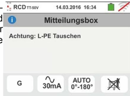
8. Wenn der zu testende RCD-Schutzschalter während der Vortestphase (die das Gerät vor der ausgewählten Prüfung automatisch ausführt) auslöst, führt das Gerät keine Prüfung durch und zeigt einen Bildschirm ähnlich dem hier nebenstehenden an. Vergewissern Sie sich, dass der eingestellte Wert für  $I_{dN}$  dem angeschlossenen RCD-Schutzschalter entspricht, und dass alle dem Schutzschalter nachgelagerten Verbraucher abgeklemmt sind.
