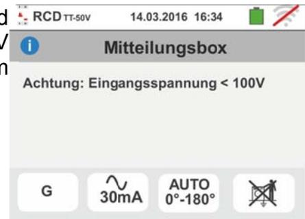
3. Wenn das Gerät kein Signal an der Eingangsbuchse B1 (Phasenleiter) ermittelt, zeigt es einen Warnbildschirm ähnlich dem hier nebenstehenden an und unterbricht jede Prüfung.
