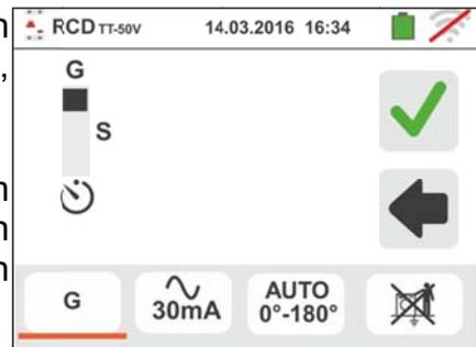
Für die Auswahl von RCD-Schutzschalter des verzögerten Typs zeigt das Gerät den folgenden Bildschirm an:
