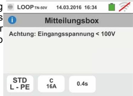
3. Wenn das Gerät kein Signal an der Eingangsbuchse B1 (Phasenleiter) ermittelt, zeigt es einen Warnbildschirm ähnlich dem hier nebenstehenden an und unterbricht jede Prüfung.
