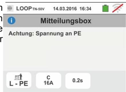
9. Erkennt das Gerät eine Spannung VN-PE >50V (oder > 25V je nach den Einstellungen), führt es keine Prüfung durch und zeigt einen Bildschirm ähnlich dem hier nebenstehenden an
