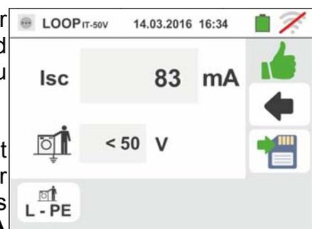
5. Bei negativem Prüfergebnis (Berührungsspannung  $U_b > 50V$  oder  $> 25V$ ) zeigt das Gerät die nebenstehend abgebildete Bildschirmseite.
