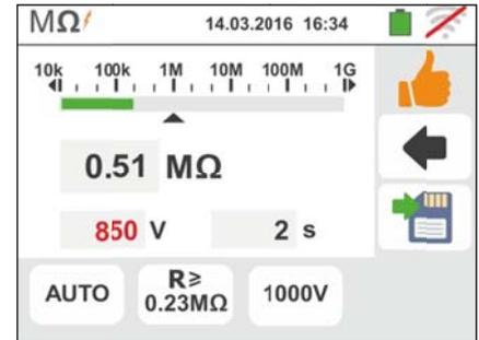
2. Erkennt das Gerät eine Spannung über ca 10V an den Eingangsbuchsen, führt das Gerät die Prüfung nicht, durch und erzeugt es ein langes Tonsignal und zeigt einen Bildschirm ähnlich dem hier nebenstehenden an.
