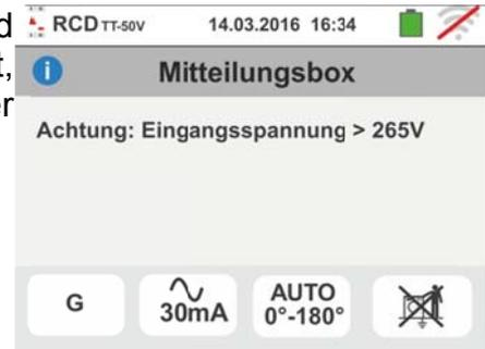
2. Wenn die Spannung zwischen den Eingängen B1 und B4 und den Eingängen B1 und B3 niedriger als 100 V ist, zeigt das Gerät einen Warnbildschirm ähnlich dem hier nebenstehenden an und unterbricht jede Prüfung.
