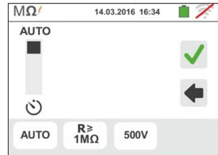
3. Berühren Sie das Symbol zur Nullstellung des Wertes im Timer-Feld und stellen Sie den Wert in Sekunden zwischen **1s** und **999s** mit der virtuellen Tastatur ein. Bestätigen Sie die Einstellung und kehren Sie zum Anfangsbildschirm der Messung zurück.
