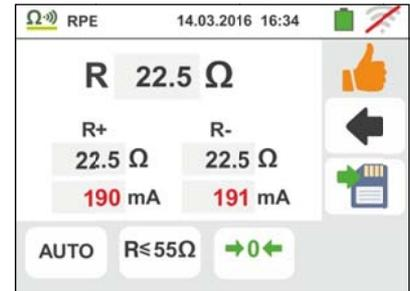
2. Wird bei Anwendung des Modus ein Widerstand von mehr als  $2\Omega$  zwischen den Eingangsbuchsen erkannt, so wird ein Bildschirm ähnlich dem hier nebenstehenden angezeigt und das Gerät verbleibt in einem Zustand ohne gespeicherten Kalibrierungswiderstand. Das Symbol erscheint auf dem Display und gibt den auf Null gestellten Wert der Kalibrierung an (z.B. wenn der Messvorgang mit offenen Messanschlüssen durchgeführt wird).
