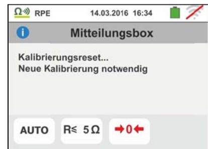
4. Erkennt das Gerät eine Spannung über ca 10V an den Eingangsbuchsen, führt das Gerät die Prüfung nicht, durch und erzeugt es ein langes Tonsignal und zeigt einen Bildschirm ähnlich dem hier nebenstehenden an
