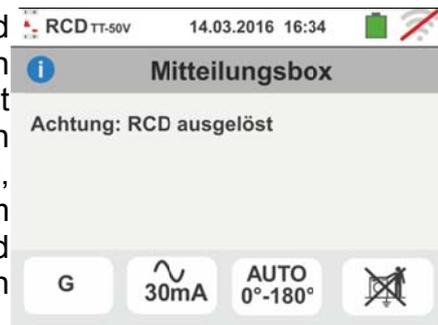
9. Falls das Gerät ein gefährliches Potenzial auf dem PE-Leiter ermittelt, unterbricht es die Prüfung und zeigt die nebenstehende Meldung an. Überprüfen Sie die Leistung des PE-Leiters und der Erdinstallation. Diese Meldung kann auch bei zu kurzem Drücken der **GO/STOP** Taste erscheinen
