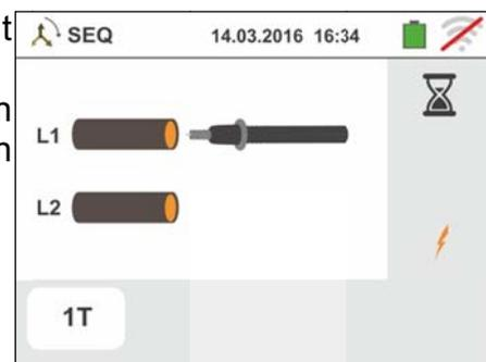
6. Am Ende der Ermittlung der Phase L1 schaltet sich das Gerät auf Standby und wartet auf das Signal der Phase L2. Dabei wird das Symbol "abgetrennter Tastkopf" angezeigt, wie im hier nebenstehenden Bildschirm.
