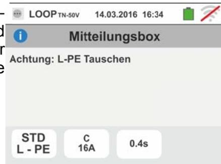
8. Erkennt das Gerät eine gefährliche Spannung auf dem PE-Leiter, führt es keine Prüfung durch und zeigt einen Bildschirm ähnlich dem hier nebenstehenden an. Diese Meldung kann auch bei zu kurzem Drücken der **GO/STOP** Taste erscheinen
