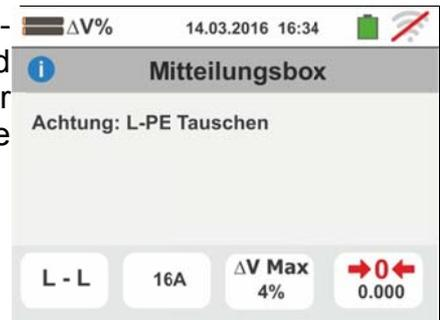
8. Erkennt das Gerät eine gefährliche Spannung auf dem PE-Leiter, führt es keine Prüfung durch und zeigt einen Bildschirm ähnlich dem hier nebenstehenden an. Diese Meldung kann auch bei ungenügendem Drücken der **GO/STOP** Taste erscheinen
