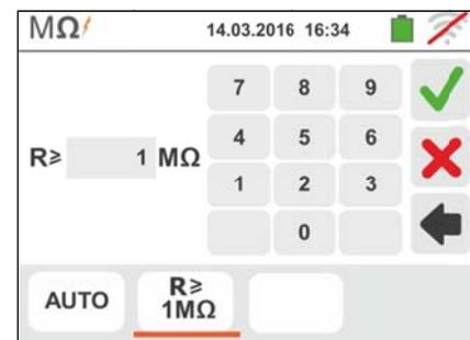
5. Berühren Sie das Symbol " $xxxV$ " zur Einstellung der DC Testspannung bei der Messung des Isolationswiderstandes. Der hier nebenstehende Bildschirm erscheint im Display.
