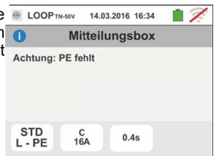
6. Erkennt das Gerät eine Vertauschung zwischen Phase- und Neutral-Leiter, führt das Gerät keine Prüfung durch und zeigt einen Bildschirm ähnlich dem hier nebenstehenden an. Drehen Sie den Schukostecker oder überprüfen Sie die angeschlossenen Einzelkabel.
