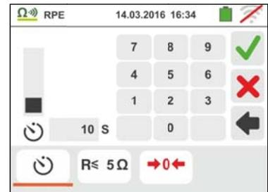
4. Berühren Sie das Symbol "R ≤ xxΩ" zur Einstellung des maximalen Grenzwertes des Widerstandes, der das Gerät mit dem gemessenen Wert vergleicht. Der hier nebenstehende Bildschirm erscheint im Display.
