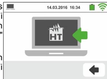
2. Aktivieren Sie die WiFi-Verbindung des PCs, auf den Sie die Daten Herunterladen möchten (schließen Sie z.B. ein WiFi-Surfstick an eine USB-Schnittstelle des PCs an) und verbinden Sie sich mit dem WiFi-Netz, den das Gerät zu Verfügung stellt (Name des Netzes "GSC60\_XXXXXX" wobei XXXXXX die Seriennummer des Geräts ist)
