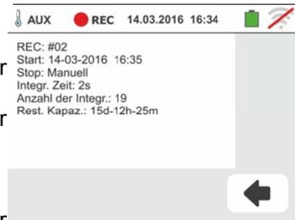
9. Drücken Sie die **GO/STOP** Taste zum Beenden der Aufzeichnung, die das Gerät im Speicher automatisch abspeichert. Die nebenstehende Meldung wird im Display angezeigt.
