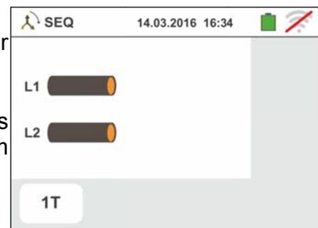
2. Bewegen Sie den Cursor der Leiste in die Stellung "1T" zur Auswahl des Tests mit einem Kabel oder in die Stellung "2T" zur Auswahl des Tests mit zwei Kabeln.
