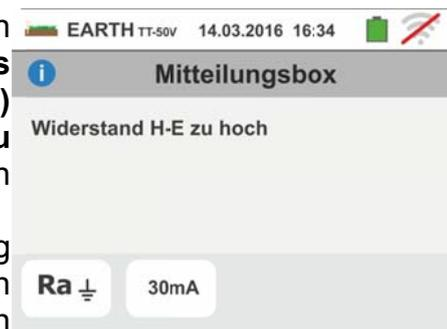
4. Am Anfang der Messung prüft das Gerät die Situation der Buchsen B2 (S) und B3 (ES). Falls die Leiter in der Installation vertauscht sind, unterbricht das Gerät die Prüfung und zeigt die nebenstehende Meldung an
