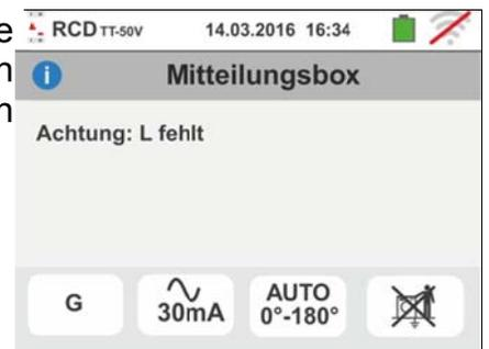
4. Wenn das Gerät kein Signal an der Eingangsbuchse B4 (Neutralleiter) ermittelt, zeigt es einen Warnbildschirm ähnlich dem hier nebenstehenden an und unterbricht jede Prüfung.
