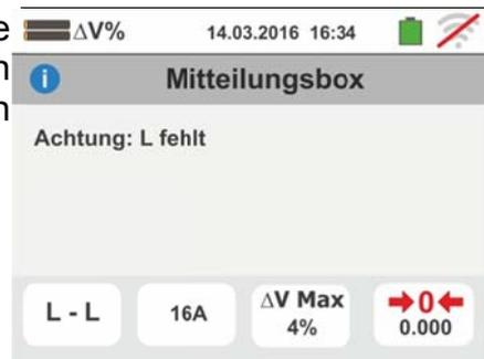
4. Wenn das Gerät kein Signal an der Eingangsbuchse B4 (Neutralleiter) ermittelt, zeigt es einen Warnbildschirm ähnlich dem hier nebenstehenden an und unterbricht jede Prüfung
