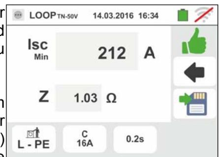
8. Bei negativem Ergebnis (berechneten minimalen Kurzschlussstrom höher als Auslösestrom der Schutzeinrichtung innerhalb der vorgegebenen Zeit) zeigt das Gerät die hier nebenstehende Bildschirmseite an.
