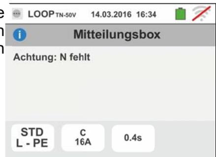
5. Wenn das Gerät kein Signal an der Eingangsbuchse B3 (PE-Leiter) ermittelt, zeigt es einen Warnbildschirm ähnlich dem hier nebenstehenden an und unterbricht jede Prüfung.
