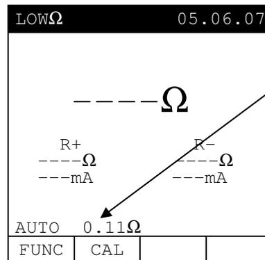
Ein numerischer Wert in diesem Feld bedeutet, dass das Instrument kalibriert wurde; Dieser Wert **bleibt für jede weitere Messung erhalten** auch, wenn das Gerät aus und wieder eingeschaltet wird.
