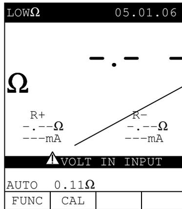
ACHTUNG: die Prüfung wurde nicht durchgeführt, wegen Spannung an den Leiterenden.
