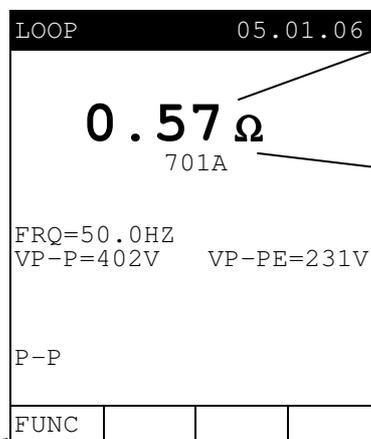
Wert der Impedanz von Phase zu Phase ausgedrückt in Phase  $\Omega$ .
