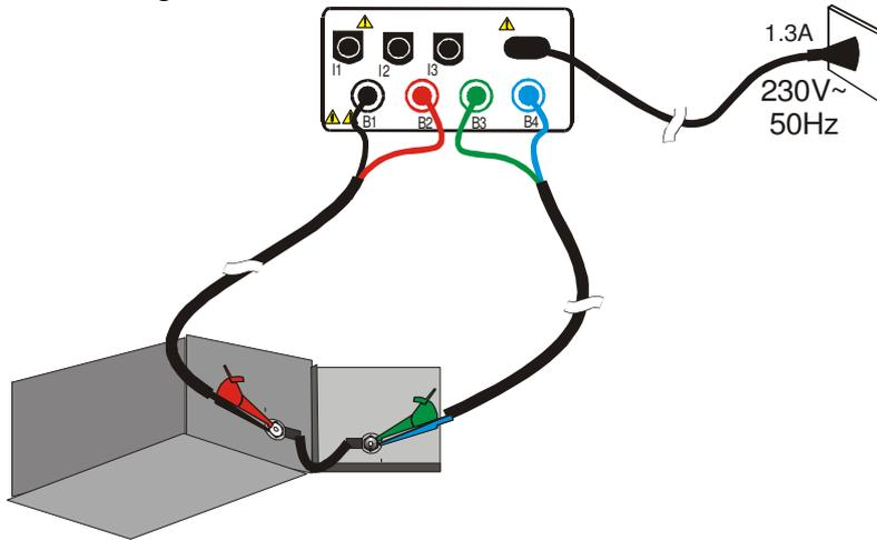
**Anschluss der Messleitungen beim LOWΩ10A Test.**
