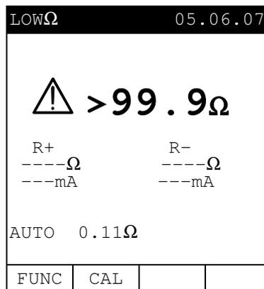
Meldung **>99.9Ω**: bedeutet, dass das Instrument einen Widerstand höher als 5Ω festgestellt hat, deshalb wird es mit einer Reset-Prozedur fortfahren.
