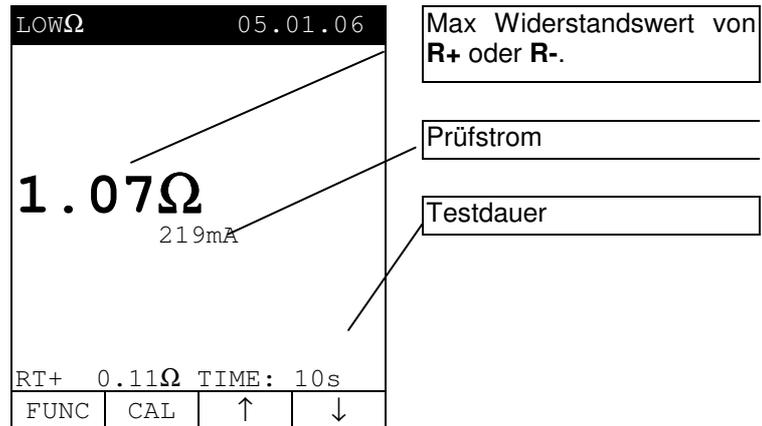
**Merke:** Wir empfehlen, Krokodilklemmen zu benutzen und nachzuprüfen, ob die Krokodilklemmen guten Kontakt mit dem zu prüfenden Leiter haben. Tatsächlich gibt das Instrument bei dieser Prüfung als Endergebnis den maximal gemessenen Wert von  $R+$  oder  $R-$  an und pendelnde Prüfspitzen anstelle von Krokodilklemmen könnten, wegen fehlerhaften Kontaktes zwischen den Prüfschnüren und dem zu prüfenden Leiter, zu einem fehlerhaften Ergebnis führen.
