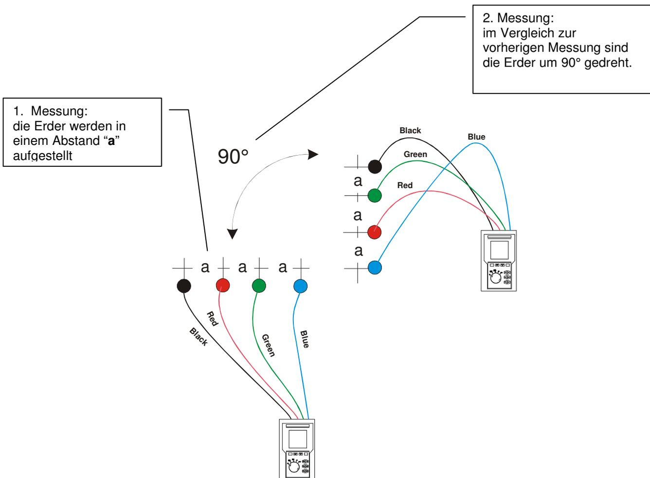
Der spezifische Widerstandswert wird mit folgender Formel berechnet:
