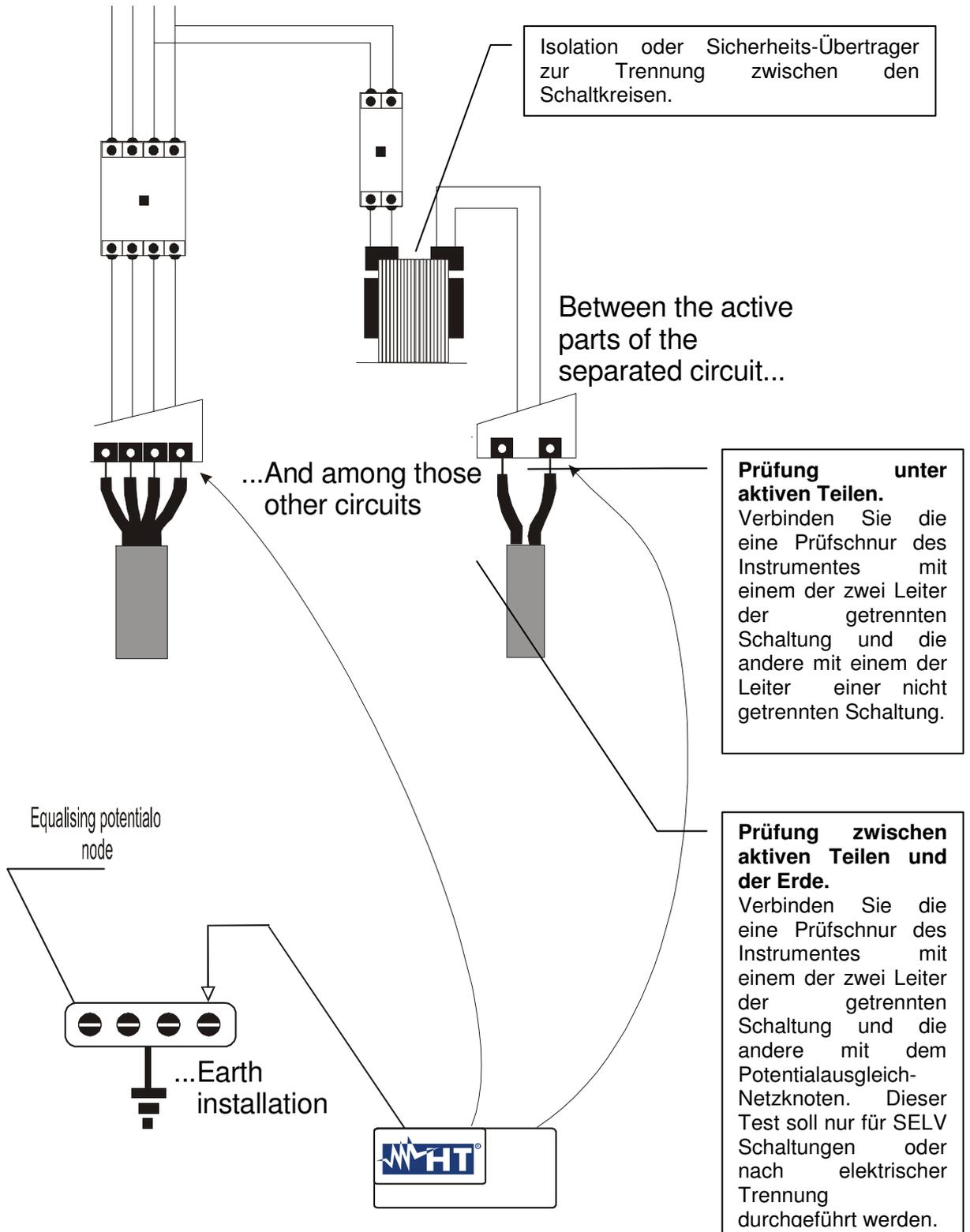
**Messung der Trennung zwischen Installationsschaltungen**
