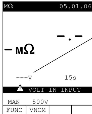
ACHTUNG: die Prüfung kann nicht durchgeführt werden. Überprüfen Sie, dass die Prüfschaltung nicht unter Spannung steht.
