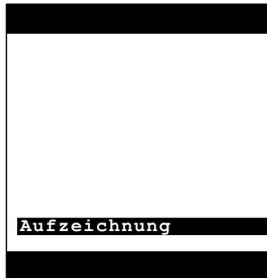
Diese Seite drückt aus, dass eine Aufzeichnung läuft, aber die aktuelle Drehschalterposition damit nicht überein stimmt.
