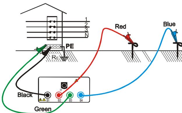
Beschaltung für eine Verbindung zur 3 Punkt Erdungsmessung
