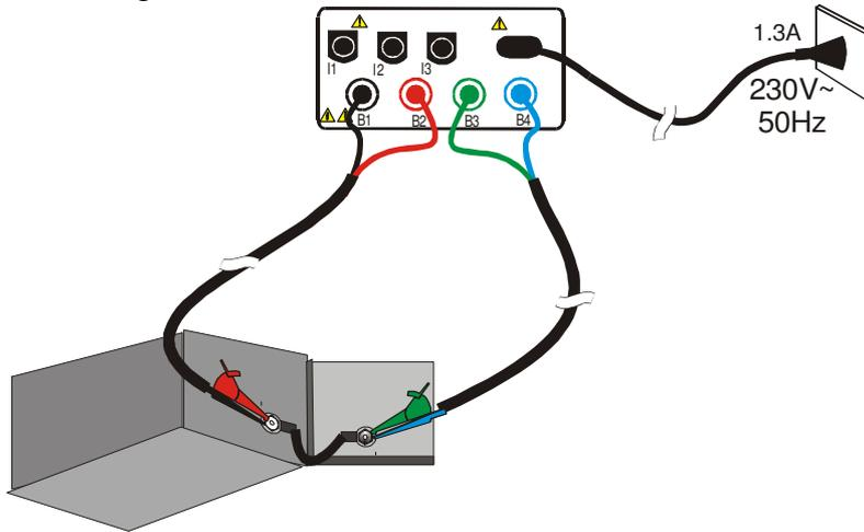
**Anschluss der Messleitungen beim LOWΩ10A Test.**
