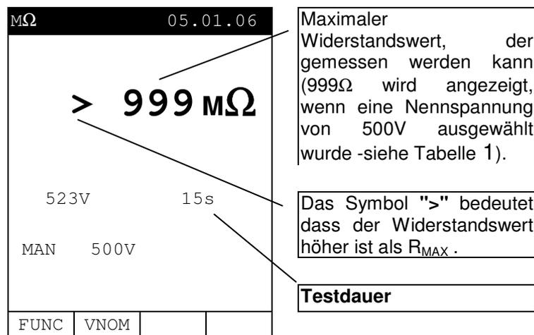
**SAVE** Das angezeigte Ergebnis kann durch **zweimaliges** Drücken der **SAVE** Taste gespeichert werden (entsprechend Absatz 9.1).
