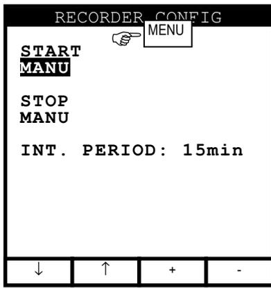
Zur Anwahl des **MANUAL** oder **AUTOMATIC** start/stop Modus, platzieren Sie den Cursor auf **MANU** oder **AUTO** mittel der Multifunktionstasten **F1** oder **F2** und wählen Sie den gewünschten Modus mittels **F3** oder **F4**.
