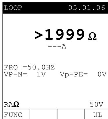
Meldung ">1999" bedeutet, dass der gemessene Widerstand höher ist, als der maximal messbare
