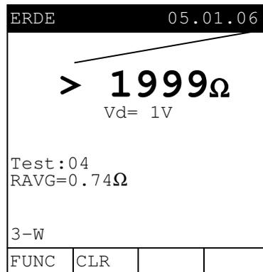
Meldung ">1999" heißt, dass der Widerstandswert höher ist als der maximal messbare Wert.
