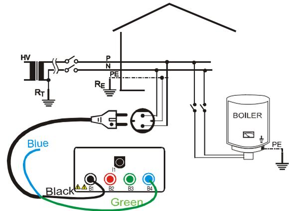
**Beispiel: Isolationsmessung zwischen Phase und Erde in einer elektrischen Installation an nicht isolierten Kabeln.** **Beispiel: Isolationsmessung zwischen Phase und Erde in einer elektrischen Installation mit Schuko Kabeln.**
