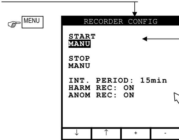
Zur Auswahl des **MANUELLEN** oder **AUTOMATISCHEN** Start/Stop Modus, platzieren Sie den Cursor auf **MANU** oder **AUTO** mittels der Multifunktionsstaste **F1** oder **F2** und wählen den gewünschten Modus mit **F3** oder **F4**.
