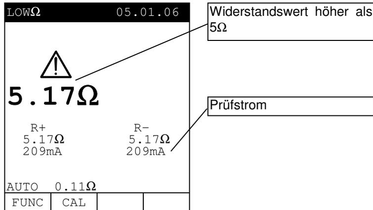
**SAVE** Das angezeigte Ergebnis kann durch **zweimaliges** Drücken der **SAVE** Taste gespeichert werden (entsprechend Absatz 9.1).
