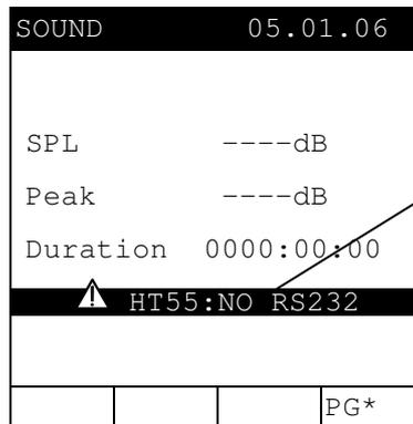
Das Instrument kann nicht mit der Sonde HT55 kommunizieren. Prüfen Sie, ob die Batterien nicht zu schwach sind, das Kabel und der Adapter korrekt verbunden sind.
