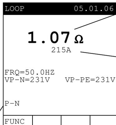
Wert der Netzimpedanz von Phase zu Neutralleiter ausgedrückt in Ω.
