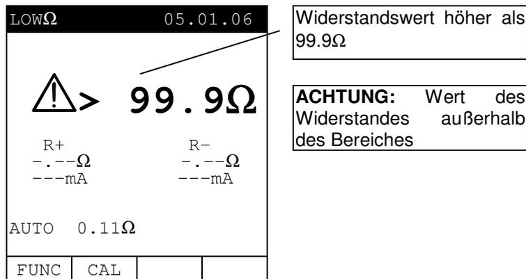
**SAVE** Das angezeigte Ergebnis kann durch **zweimaliges** Drücken der **SAVE** Taste gespeichert werden (entsprechend Absatz 9.1).
