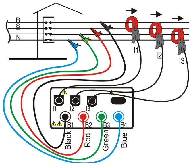
Instrumentenverbindung in einem 3-Phasen-System (4 Leiter)
