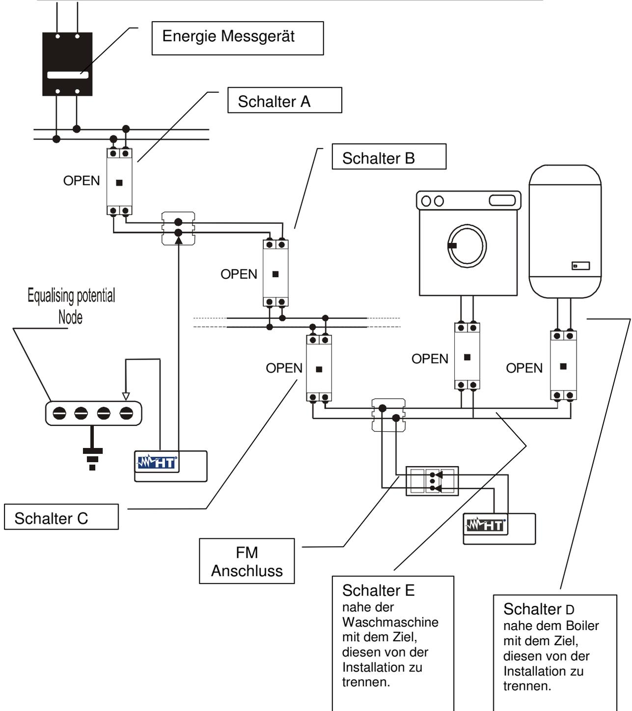
**Isolationmessungen an einer Installation.**
