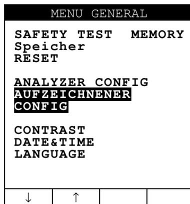
Es ist nicht möglich das **MENU** während einer Aufzeichnung oder einer Echtzeit Energie Messung zu öffnen .Diese Option erlaubt Ihnen die Überprüfung und eventuelle Änderung der Aufzeichnungsparameter und der ausgewählten Parameter (bis zu maximal 3). Der AUFZEICHNER CONFIG Modus ist in 2 getrennte Unterseiten aufgeteilt:
