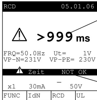
RCD Auslösezeit ist größer als die maximal messbare Zeit (dies hängt von der Art der Prüfung ab, lesen Sie folgende Tabelle).
