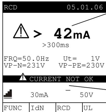
Maximaler Strom, erzeugt vom Instrument während des Tests für normale RCDs (der Anzeigewert bezieht sich auf eine AC Type 30mA RCD, in diesem Fall ist der maximal zugeführte Strom gleich  $1.4 \times I_{\Delta n}$ )
