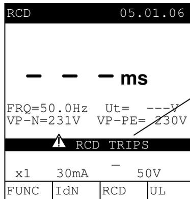
Der RCD löst zu früh aus. Prüfen Sie, ob der RCD Nennstrom korrekt ist. Möglicherweise sind einige Ableitungsströme in der Installation vorhanden. Trennen Sie alle Lasten, die unterhalb des RCD angeschlossen sind.
