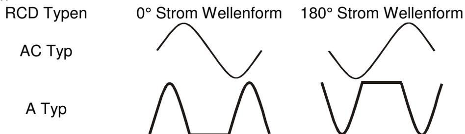
Üblicher Praxis entsprechend, wird empfohlen, die RCD Prüfung mit beiden, Phase-0° und Phase 180° und auch mit **x 1** und **▬** durchzuführen.
