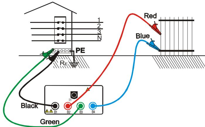
Beschaltung für eine Widerstandsmessung zwischen externen Leiterteilen und dem Erdsystem
