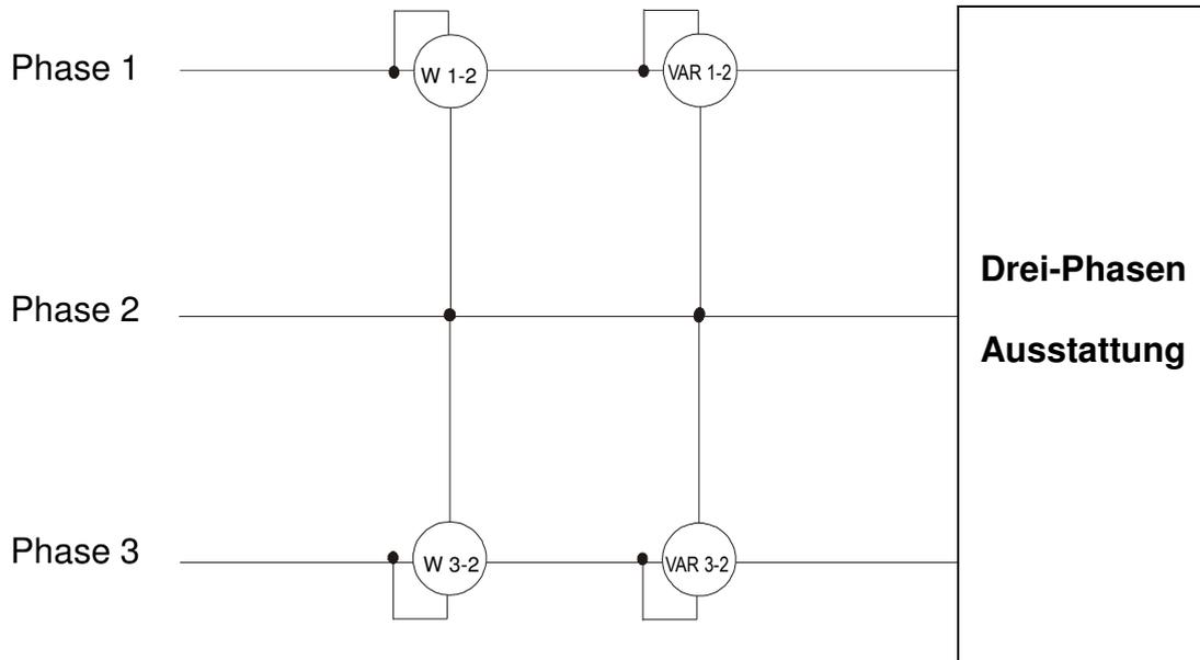
In diesem Fall wird das Potential einer der drei Phasen (zum Beispiel, Phase 2) als Bezugs-Potential herangezogen. Die Gesamtwerte von Wirk-, Blind- und Scheinleistung werden als Summe der Anzeigen einer Reihe von Wattmetern, VARmetern und VAmern ausgedrückt.
