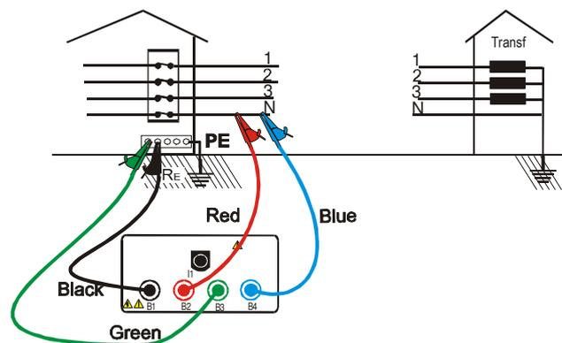
Beschaltung für eine Verbindung zur 2 Punkt Erdungsmessung
