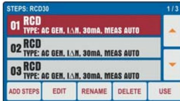
Abb. 68 : AUTOTEST Menü – Einschließlich Tests in einem Prüfablauf
