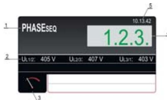
Abb. 38: Bildschirmseite der Testergebnisse der PHASENFOLGE
