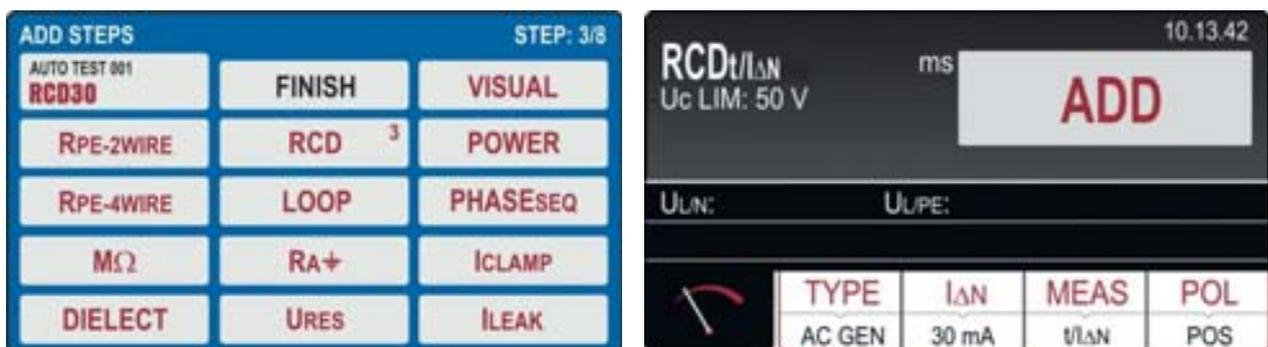
Abb. 69 : AUTOTEST Menü – Einschließlich Tests in einem Prüfablauf
