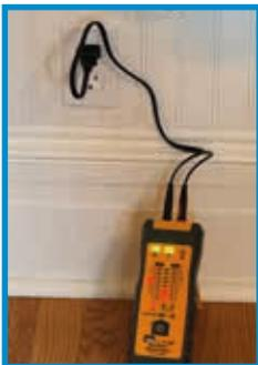
Halten Sie den Empfänger nahe an den Sender, um die Signalstärke zu überprüfen. Diese wird mit der Lightning Bolt-Anzeige bestätigt.
