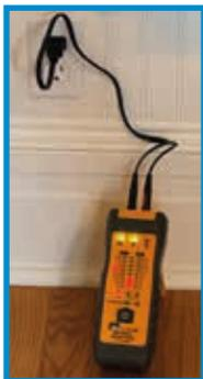
Halten Sie den Empfänger nahe an den Sender, um die Signalstärke zu überprüfen.
