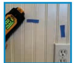
Fahren Sie mit der Verfolgung des höchsten Messwertes fort, bis Sie das Ende des Kabels gefunden haben.
