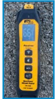
Hinweis: Das stärkste Rückverfolgungssignal wird immer durch den Anschluss an einen geschlossenen Stromkreis mit aktiver Last erreicht
