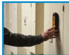
Wenn zwei Schalter 99 anzeigen oder nahe beieinander liegen, drücken Sie die Empfindlichkeitstaste einmal, um die Empfindlichkeit des Empfängers um eine Stufe zu verringern und erneut zu scannen.
