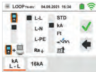
Impedanzmessung Auswahl der Messmethode
