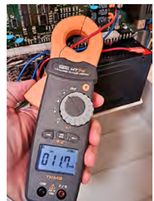
Messung an der Alarmanlage (Ladestrom / Betriebsstrom)
