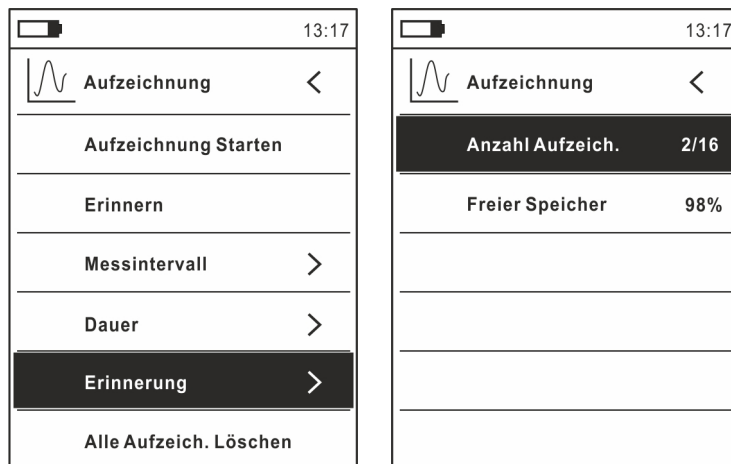
Abb. 41: Data Logger Funktion – Inhalt des Speichers
