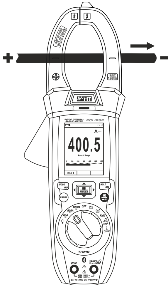
Abb. 31: Verwendung des Geräts zur Messung von DC Strom
