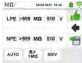
AUTO Isolationsmessung mit L/N und L/PE Ergebnisanzeige
