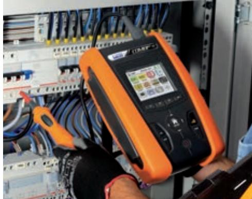
**Ein Messgerät für alle elektrischen Sicherheitstests gemäß VDE 0413 (EN 61557)**
